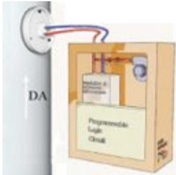
È possibile regolare automaticamente il numero di giri del Ventilatore o il grado di chiusura di una Serranda mediante un trasduttore di Pressione differenziale che fornisce un segnale analogico in corrente (4-20 mA) o in tensione (0-10 V) utilizzabile come segnale di retroazione per un Inverter PID (non rappresentato in figura). In caso di aria polverosa è disponibile un sistema di pulizia della Sonda programmabile tramite PLC.
